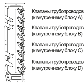
Рисунок 43 - Клапаны трубопроводов внешнего блока системы «1-4»
